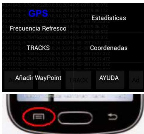
**Frecuencia de Refresco:** Muestra un submenú que permite seleccionar la frecuencia de captura de coordenadas. Capturar coordenadas con mucha frecuencia disminuirá en mayor medida la autonomía de la batería.
